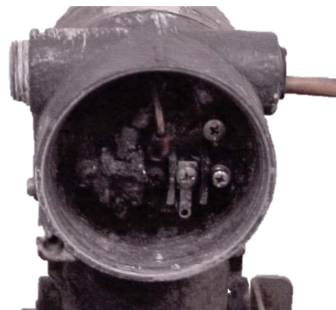
Abbildung 12: Korrosion einer Klemmanordnung in einem Transmittergehäuse
